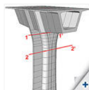
Umístění žezů pro posouzení pilířů
