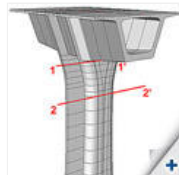
Anordnung der Messungsschnitte am Pfeiler
