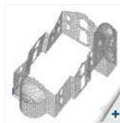
Verformtes FE-Netz der 1. Eigenform
