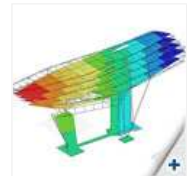
Scia Engineer - mode propre Harbour House à Anvers (projet en cours)
