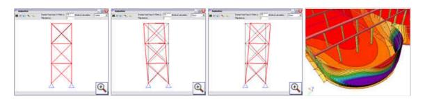
Dieses Werkzeug ist besonders bei **dynamischen Berechnungen** nützlich. Das Fenster "Bewegte Bilder" kann beispielsweise die Schwingungen einer Struktur infolge eines Erdbebenlastfalls darstellen.
