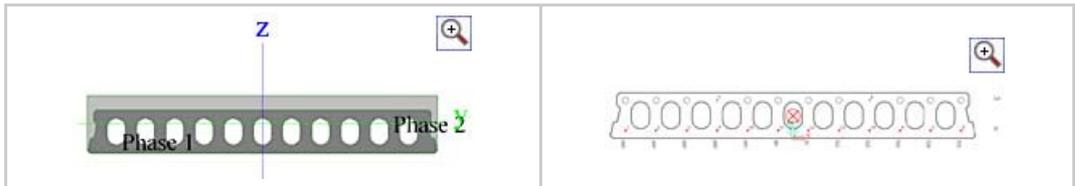
Im Rahmen der Hauptanwender-Philosophie **definiert der leitende Ingenieur eine Vorlage für Berechnung und Dokumentation** einer Hohlkörperplattenberechnung in SCIA•ESA PT. **Weitere Anwender können diese Vorlage in SCIA•ODA oder SCIA•ESA PT ausführen.** Sie müssen lediglich die Parameter, die der Hauptanwender definiert hat, eingeben. Das reduziert das Fehlerrisiko und auch die Kosten für wiederkehrende Ingenieur Tätigkeiten beträchtlich. ▲ top
