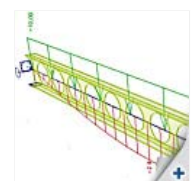
Vervormingen op een raaftligger
