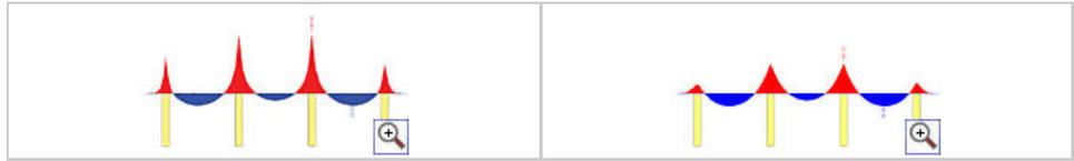
Die Abbildungen zeigen deutlich, dass der Wertebereich des Biegemoments  $m_x$  von  $\langle -185, 38 \rangle$  auf  $\langle -82, 36 \rangle$  umgelagert wurde.
